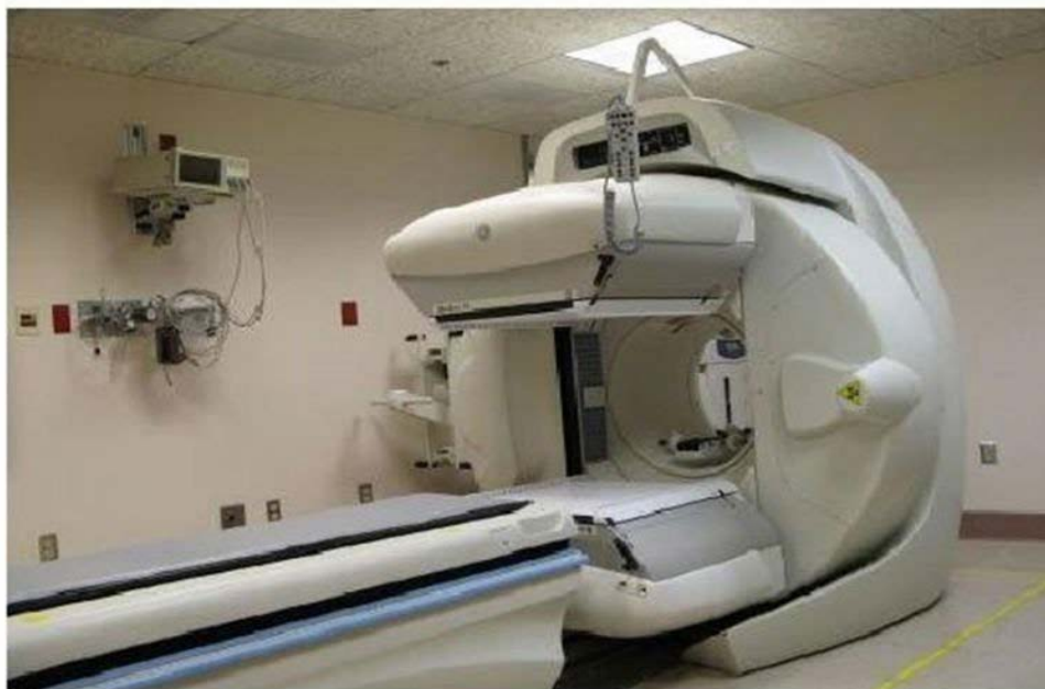
Rajah 2.3 Kamera gamma dengan keupayaan untuk memperoleh satah seluruh badan dan tomografi imej
